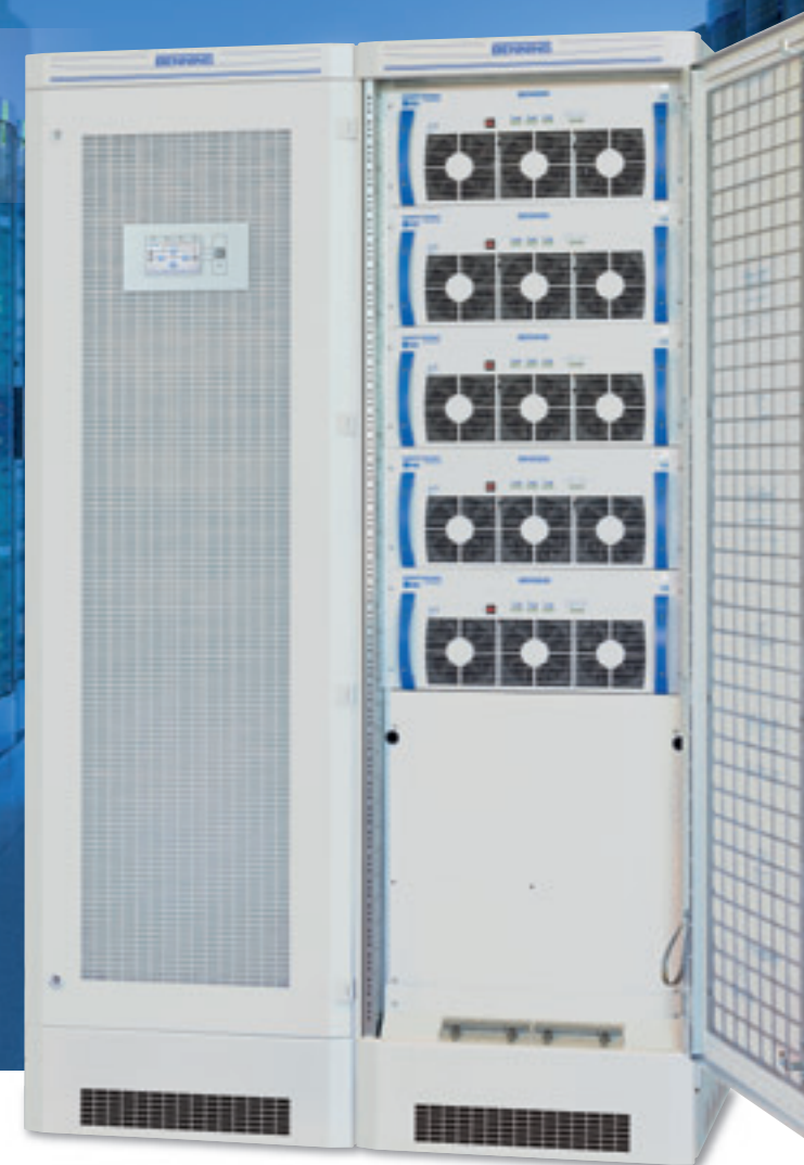
ENERTRONIC modular SE mit 40 kVA Leistungsmodulen und Verteilschrank, Ausgangsleistung 160 kVA (n+1)
